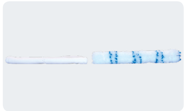
Abbildung 1: Darstellung der unterschiedlichen Materialdicken zwischen Einwegwischbezug (links) und Mehrwegwischbezug (rechts)
