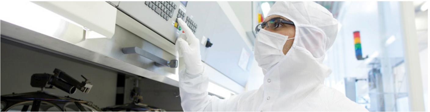
Durch das Umlaufregal von Hänel konnte die benötigte Lagerbodenfläche im Reinraum beibehalten werden und das bei einer Verdreifachung der Lagerkapazität von 12 auf 36 Wafer-Kalottenträger.
