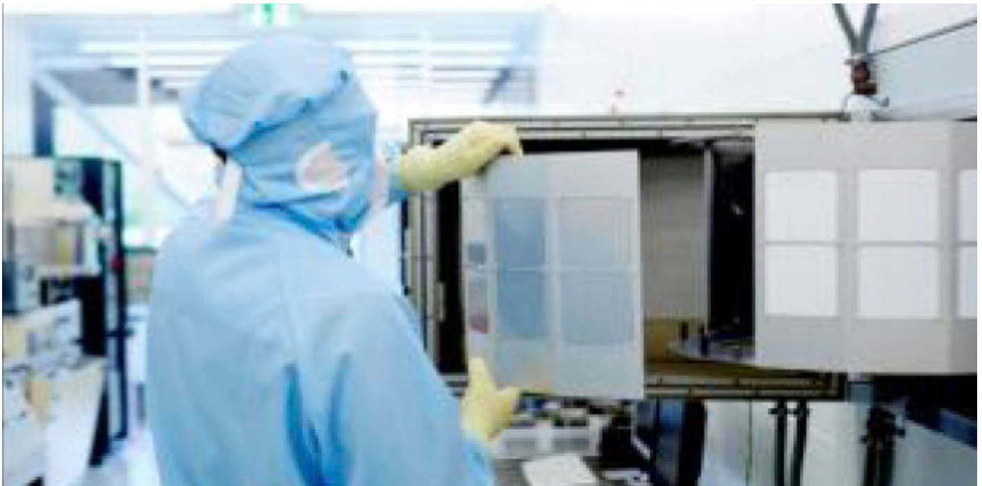
In den neuen Reinräumen der Innovative Sensor Technology IST AG wird in der Beschichtung Platin von höchster Reinheit auf ein Keramiksubstrat „gesputtert“ (geschossen).
