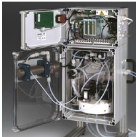
Das automatische Partikelzählensystem Pamas WaterViewer ist für Wasseranwendungen konzipiert und hat sich bei der Partikelanalyse von Trinkwasser, Rohwasser, Industrierwasser und Abwasser bewährt. Die Messung erfolgt online und kontinuierlich während des Betriebs. Sobald zuvor definierte Grenzwerte überschritten werden, schlägt das Gerät sofort Alarm. Mit der optional erhältlichen Multiplexer-Einheit kann der WaterViewer an bis zu 32 Messstellen angeschlossen werden und auf diese Weise bis zu 32 Messpunkte überwachen.
