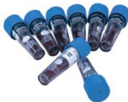
Abb_05 : Selbstentwickelnde biologische Indikatoren (SCBI)
