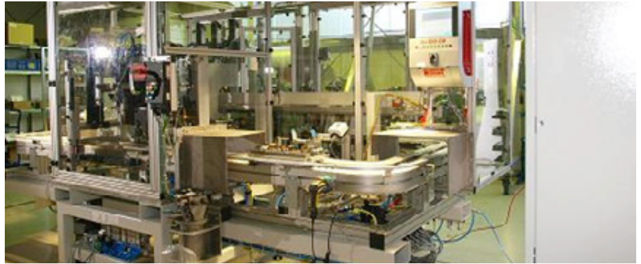
Im item pluspartner-Programm werden Kompetenzen gebündelt: gezeigt in einer Maschineneinhausung für eine Anlage zur Kolbenvormontage.
