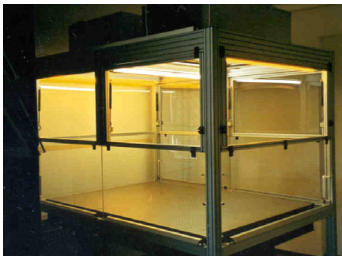
Bild 1: Laserschutzfolien bieten nicht immer eine hinreichende Abschirmung, da der Wandanschluss an den Kabelkanälen nicht gewährleistet ist.
