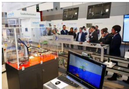
Es wurde eine Demoanlage aufgebaut, deren Grundlage ein Bandsystem der Schnaithmann Maschinenbau GmbH bildete. Um dieses herum dockten sich die einzelnen Firmen mit ihren Lösungen an, so dass ein vollständiges System entstand. (Quelle: Nerling Systemräume)
