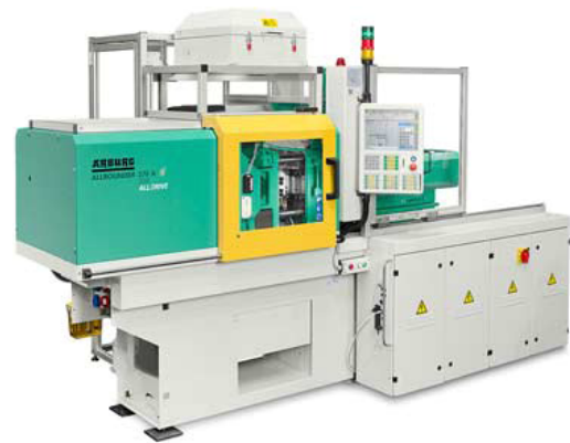
Spezielle Mikroproduktionszelle: Ein elektrischer Allrounder 270 A, die neue Mikrospritzeinheit und ein Robot-System Multilift 3+1 bilden eine flexible Systemlösung für die Fertigung von Mikrobauteilen. (Foto: Arburg)
