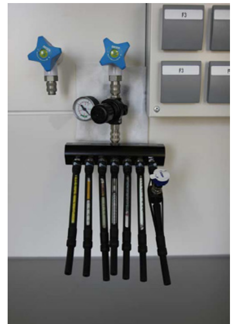
Abbildung 6: Visuelle Bewertung von geringen Ölkonzentrationen und Spurengasen mittels Ölmpaktor.
