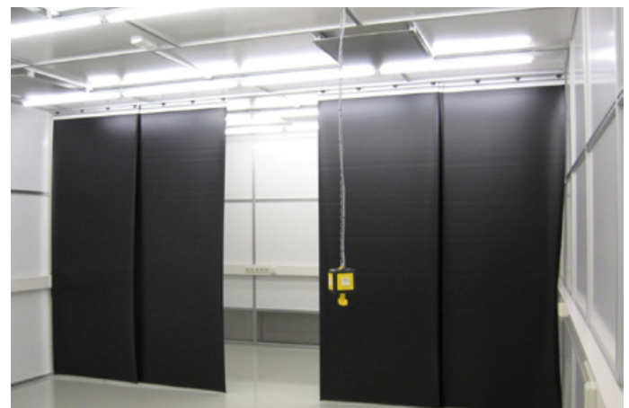
Bild 1: Laserschutzfolien bieten nicht immer eine hinreichende Abschirmung, da der Wandanschluss an den Kabelkanälen nicht gewährleistet ist.
