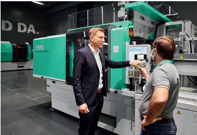
Ein Highlight des „Arburg Summits: Medical 2020“: Die Produktion der LSR-Maske auf einem elektrischen Allrounder 570 A, live präsentiert von Manuel Frick. (Foto: Arburg)
