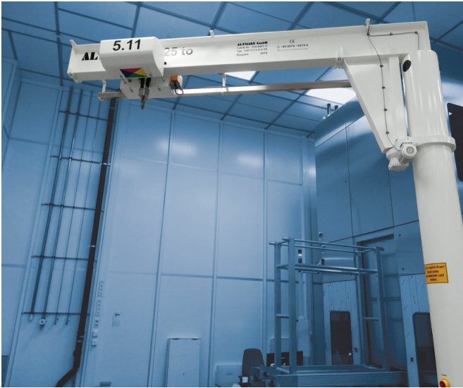
Säulenschwenkkran, 1,25 to Tragkraft, Heben, Katzfahren und Schwenken Umrichter geregelt 0,05 m/min bis 5,0 m/min Fahrgeschwindigkeit
