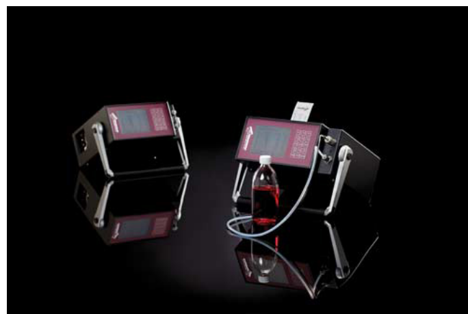
Der tragbare Partikelzähler PAMAS S40 misst den Verschmutzungsgrad von Flüssigkeiten online oder offline. Für eine Onlinemessung wird das Gerät an ein laufendes System angeschlossen, wo es die Reinheitskontrolle der Betriebsflüssigkeit (z.B. Hydrauliköl) direkt vor Ort vornimmt. Offlinemessungen aus Probenflaschen sind ebenfalls möglich. Der Partikelzähler ist in zahlreichen Produktvarianten für die Analyse von Öl, Treibstoff, Skydrol® oder wasserbasierte Flüssigkeiten erhältlich. (Foto: PAMAS)
