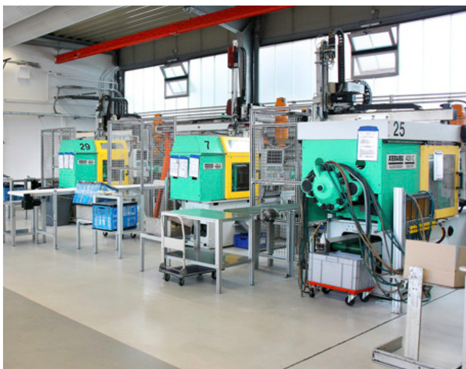
Die Komponenten der Stuhlnahmeröhrchen werden auf Allroundern in einem Sauberraum produziert. (Foto: Maier + Partner)
