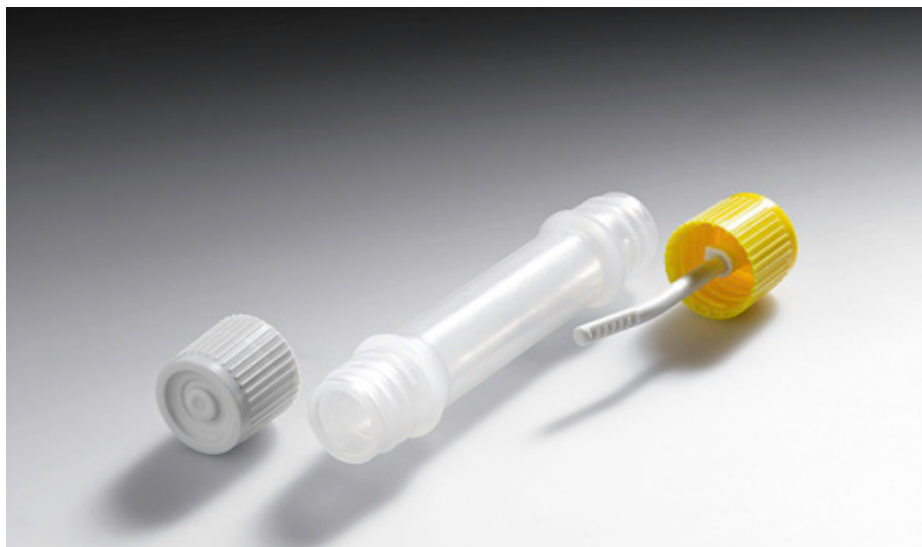
Das Stuhlnahmeröhrchen – das patentrechtlich geschützt ist – besteht aus einem transparenten Röhrchen, einem Abstreiftrichter, einem Schraubverschluss und einem Dosierstab mit spezieller Dosierspitze. (Foto: Arburg)
