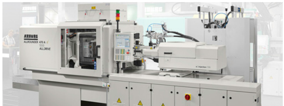
Der auf der Medtec Europe 2015 präsentierte elektrische Allrounder 470 A ist speziell für die Verarbeitung von LSR und für den Einsatz in der Medizintechnik ausgestattet. (Foto: Arburg)
