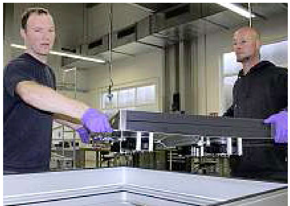
Torsten Sander und Ralf Kügler setzen eine Lüfterplatte mit Vorfilter auf. (Foto: Angelika Schimmel, OTZ)
