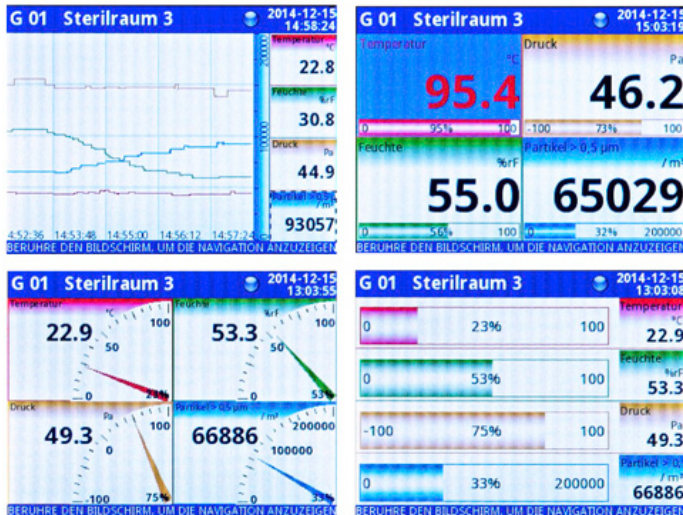
Abb. 2: Die Messwerte immer anschaulich im Blick – mit den vier über Touch-Panel wählbaren Ansichten des PUC 44.
