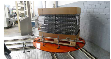
Die fertige Palette auf dem Weg zur Schrumpfanlage.
