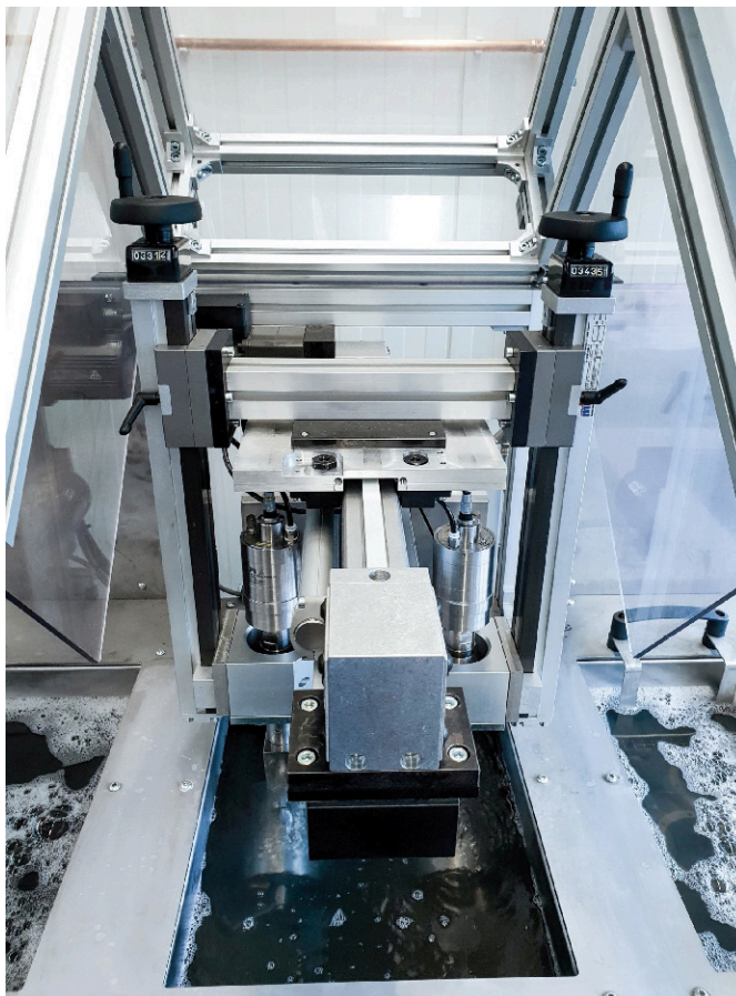
Um die Entgratspezifikation gratfrei und scharfkantig erfüllen, konzipierte das Unternehmen eine kombinierte Anlage für das Entgraten und Reinigen mit Ultraschall.
