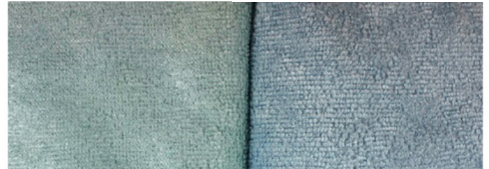
Abb. 2: Farbunterschiede der Reinigungstücher aus Mikrofaser vor und nach der Ausrüstung mit Kupferpigmenten. ©Hohenstein Institute
