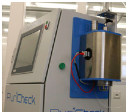
Abbildung 7: PuriCheck - seriennahes Messsystem zur Überwachung von Partikeln in Bauteilen und Fertigungsprozessen.
