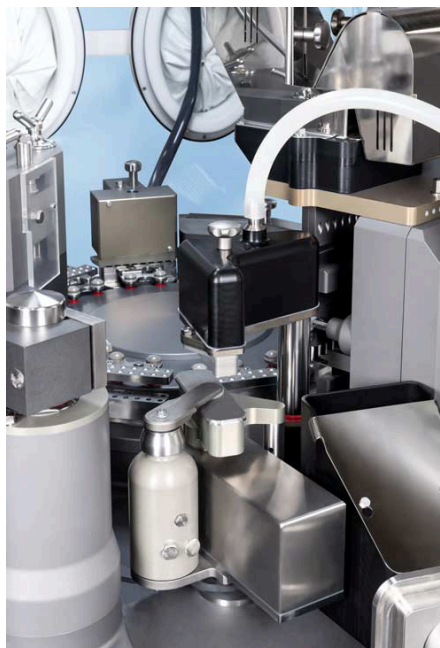
Bosch GKF 2600 erstmals mit integrierter Wiegestation: Das integrierte „Net Weight Detection System“ (NWDS) sorgt im Falle abweichender Füllmengen für automatische Korrekturen bei Mikrodosierung und Pelletfüllung. (Foto: Bosch)
