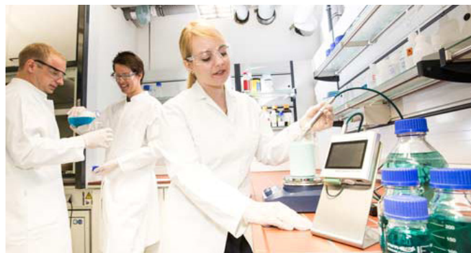
Endress+Hauser hat SensAction übernommen. Die LiquidSens-Systeme des Unternehmens bestimmen die Konzentration von Flüssigkeiten in Prozess und Labor mit Hilfe akustischer Oberflächenwellen.
