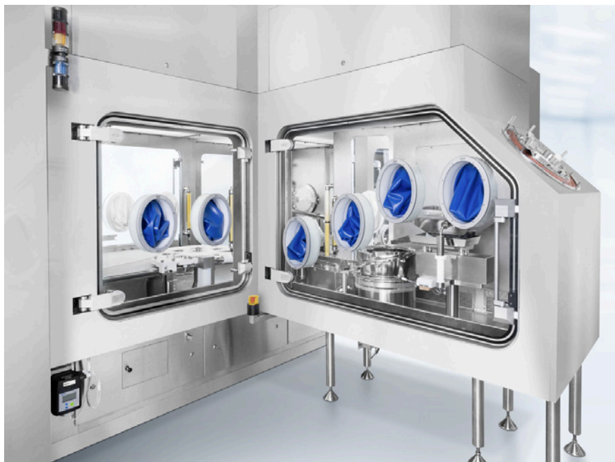
Komplettiertes Portfolio für Barriere- und Isolatortechnik: Bosch zeigt auf der Interpack, wie Pharmahersteller die Maschinenbediener mit verschiedenen Barriere-technologien vor hochpotenten Substanzen schützen können. (Foto: Bosch)
