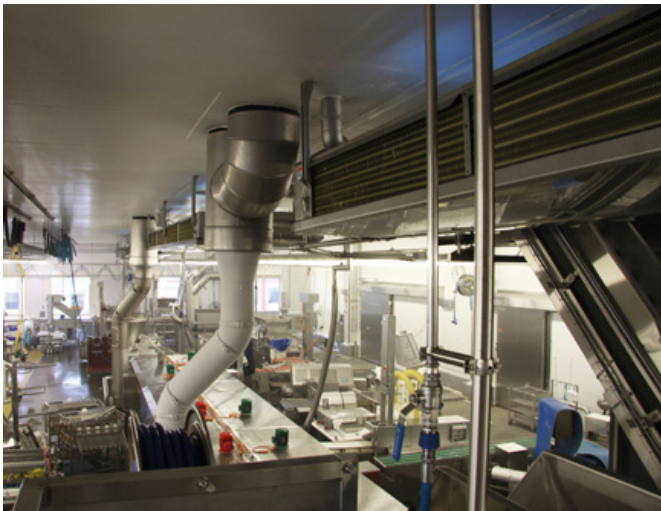
Im März 2018 wurden insgesamt 20 UVC-Module zur Oberflächenentkeimung installiert. Im November 2018 folgte ein Ausbau mit acht weiteren Einheiten. (Quelle: sterilAir AG)
