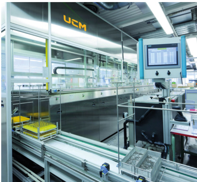
Durch die kundenspezifische Prozess- und Anlagenentwicklung erfüllen die Ultraschall-Reinigungssysteme höchste partikuläre und filmische Sauberheitsanforderungen stabil und effizient. (Bildquelle: UCM AG)
