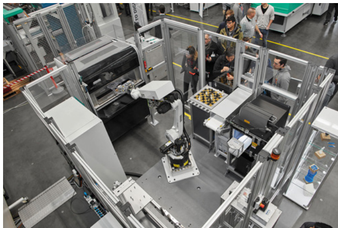
Ein Besuchermagnet war die Weltpremiere der „AM Factory“. Hier war zu erleben, welchen Mehrwert der Freeformer 300-3X für das Additive Manufacturing mit vollautomatisierten und IT-vernetzten Fertigungszellen bietet. (Foto: Arburg)
