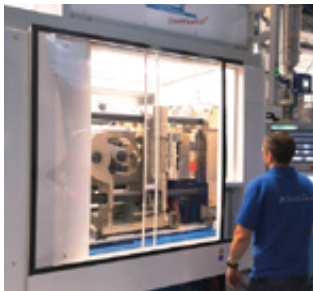
Eine Einhausung mit Laminar-Flow-Aufsatz spült das Produkt schon während des Spritzgussprozesses mit Reinstluft.
