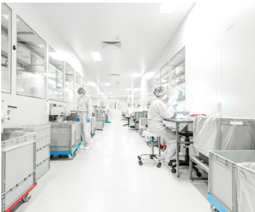
Reinraumproduktion bei Riegler am Standort Mühlthal: In insgesamt 10 Reinräumen der ISO Klasse 7 an drei Standorten werden Systeme für die Diagnostik, Medizintechnik- und Pharmabranche produziert.
