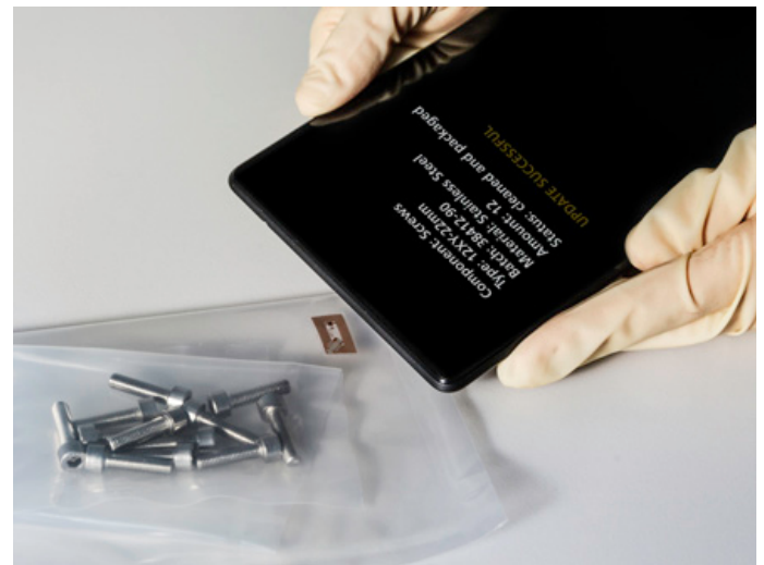
NFC-Tags zur Nachverfolgung der Bauteilreinheit (Quelle: Fraunhofer IPA)
