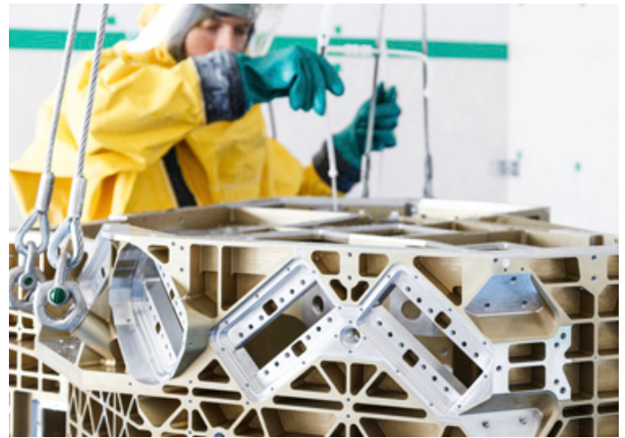
Vorreinigung eines massiven Satellitenbauteils (Quelle: Fraunhofer IPA)
