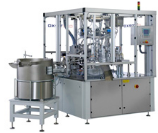
Mit der Rundtaktanlage von Contexo können Anwender Trockenmittelstopfen in sechs aufeinander abgestimmten Arbeitsschritten effizient und reproduzierbar montieren. (Bildnachweis: Contexo GmbH)
