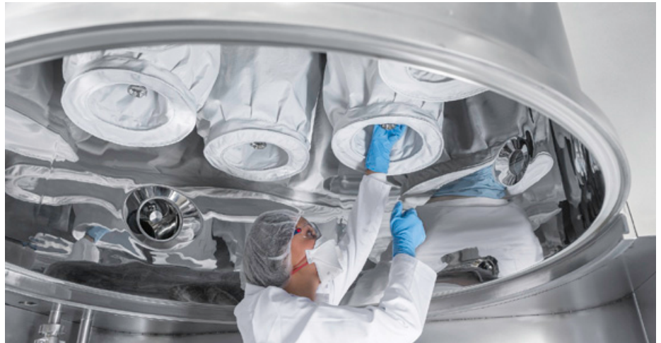
Entscheidend für hohe Ausbeute: die Prozessfilter: Für eine hohe Ausbeute im Wirbelschichtmodul der neuen GranuLean hat Bosch einen neuen Prozessfilter entwickelt.
