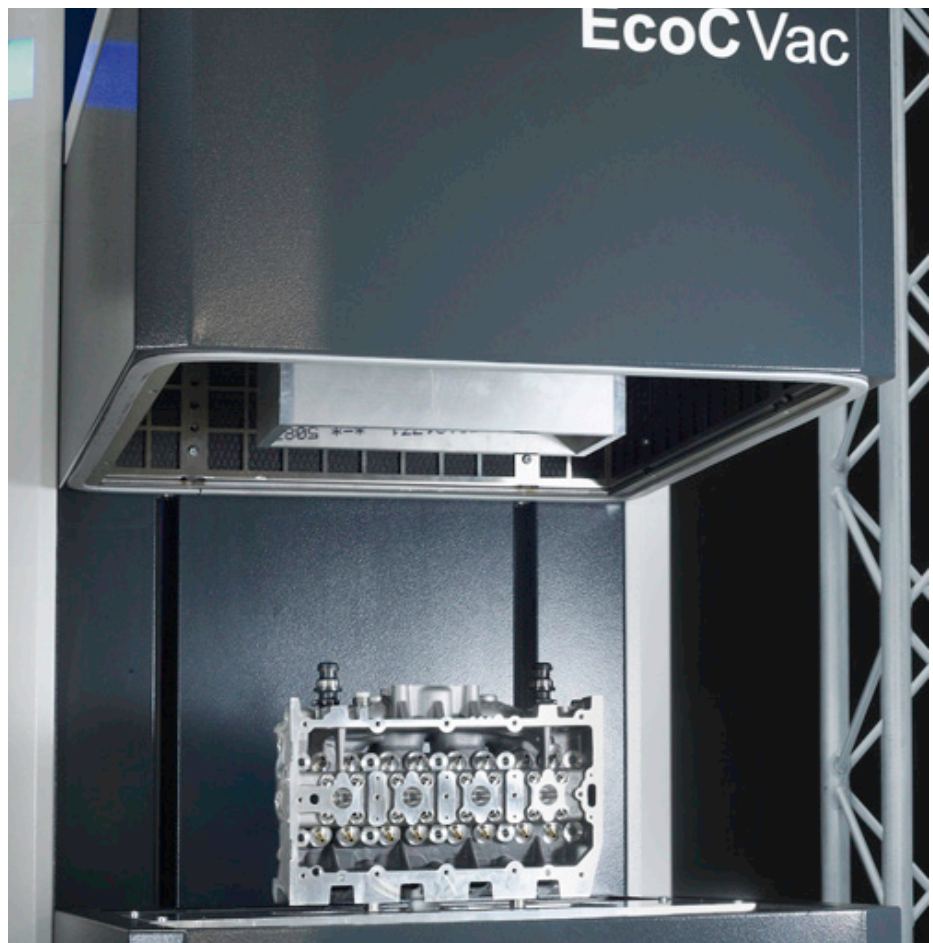
Das innovative Trockenreinigungssystem EcoCVac wurde für die energiesparende Zwischenreinigung von Powertrain-Bauteilen entwickelt. Es arbeitet ohne Druckluft. (Foto: Dürr Ecoclean)
