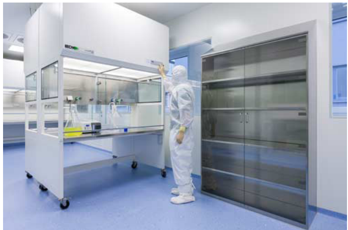
Abbildung 3 Weiss Pharmatechnik: Produktschutz-Werkbank, Typ KVF, gem. EN ISO 14644-1, kundenindividuelle, fahrbare Ausführung mit elektrischer Frontscheibe, Doppelarbeitsplatz nach hinten offen, hier für Sterilfiltrationen unter ISO Klasse 5.
