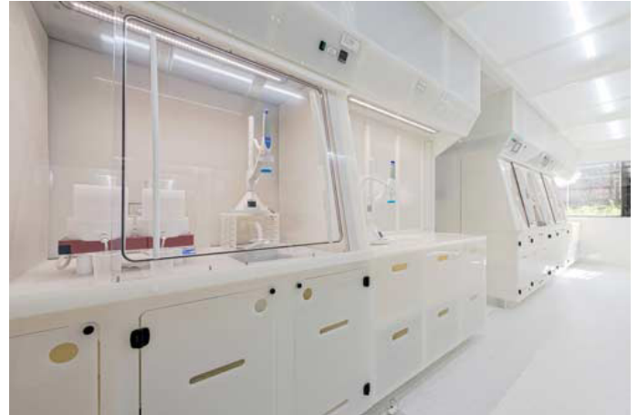
Die fünf Arbeitsplätze sind absolut metallfrei und bieten Partikelfreiheit auf dem Niveau der Klassen 4 und 5 gemäß DIN EN ISO 14644.
