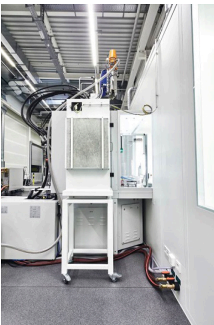
Die Spritzgussmaschine befindet sich im Schwarzbereich des neuen Produktions- und Logistikzentrums. Sie lässt sich jedoch vom Reinraum aus be- und entladen. Für den Spritzbereich wurde eine horizontal strömende Filter-Fan-Unit (FFU) an das Gehäuse der Spritzgussmaschine als Schutzzone angebaut, damit sich die Bauteile stets unter Reinraumbedingungen befinden. (Quelle: bc-technology GmbH)
