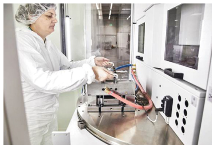
Die Spritzgussmaschine befindet sich im Schwarzbereich des neuen Produktions- und Logistikzentrums. Sie lässt sich jedoch vom Reinraum aus be- und entladen. Für den Spritzbereich wurde eine horizontal strömende Filter-Fan-Unit (FFU) an das Gehäuse der Spritzgussmaschine als Schutzzone angebaut, damit sich die Bauteile stets unter Reinraumbedingungen befinden. (Quelle: bc-technology GmbH)
