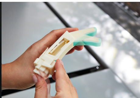
Der Freeformer 300-3X kann additiv aus drei Komponenten belastbare Funktionsbauteile in Hart-Weich-Verbindung fertigen – z. B. bewegliche Greiferfinger aus TPU, ABS und Stützmaterial. (Foto: Arburg)
