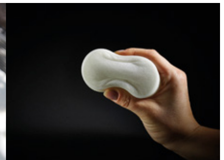
Mit dem AKF-Verfahren kann man die Bauteildichte gezielt beeinflussen. Aus dem TPE Medalist MD 12130H (Härte 32 Shore A) lassen sich Wabenstrukturen fertigen, wie sie z. B. für den Leichtbau oder als Filterelemente zum Einsatz kommen könnten. (Foto: Arburg)
