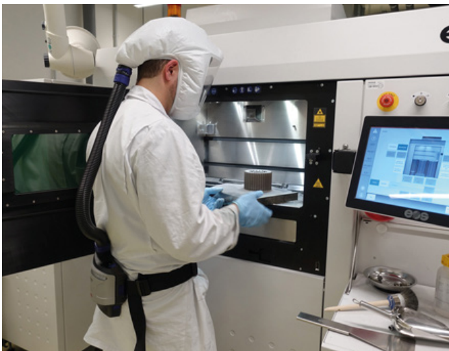
Ein Heraeus Mitarbeiter: Entnahme weltgrößtes 3D amorphe Metalle Bauteil (Quelle: Heraeus) / (Source: Heraeus)
