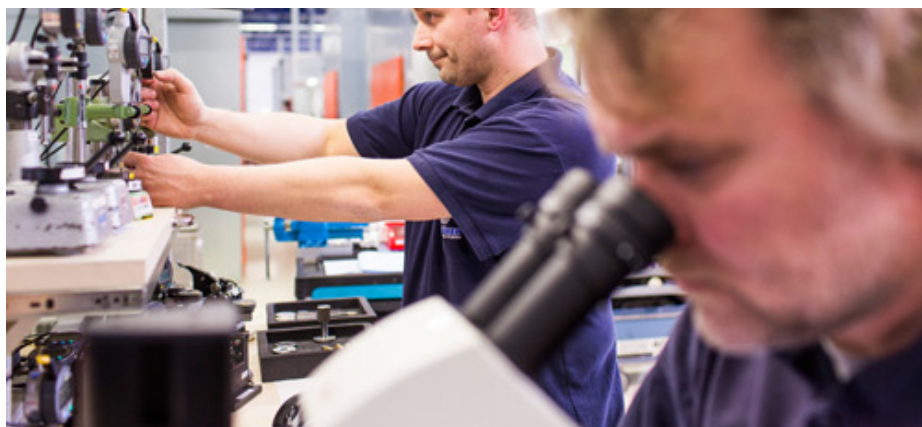
Am Prüfstand: Industriemechaniker Nikica Knezevic (links) misst Wand- und Bodendicke der produzierten Teile nach. (Foto: Frank Schinski)
