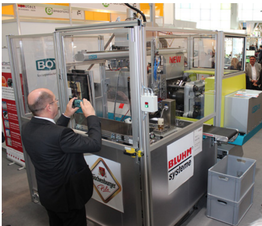
Handling-Greiferarm entnimmt fertig gespritztes Bierglas aus dem Werkzeug
