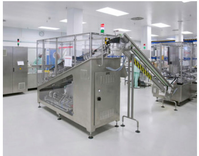
Bild 5: Alles aus einer Hand: Kompakte, vollautomatische Produktionsanlagen senken Kosten. Bei dieser Spritzenlinie greifen Kolbenstangmontage, Etikettierung, Safety-Device-Montage und Spritzenpufferung intelligent ineinander. (Foto: Bausch + Ströbel)
