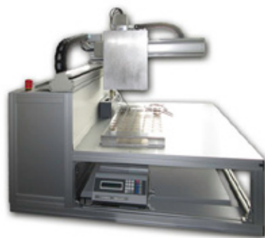
Mit dem vollautomatischen Partikelanalyzesystem PAMAS AS3 können mehrere hundert Flaschenproben am Tag unbeaufsichtigt analysiert werden. (Foto: PAMAS)
