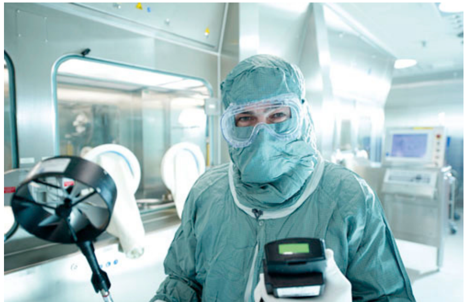
Der Mensch selbst ist die größte „Partikelschleuder“ – Sparpotentiale bietet daher das teilweise Herunterfahren der Systeme in der produktionsfreien Zeit (z.B. am Wochenende). (Quelle: STZ-EURO)
