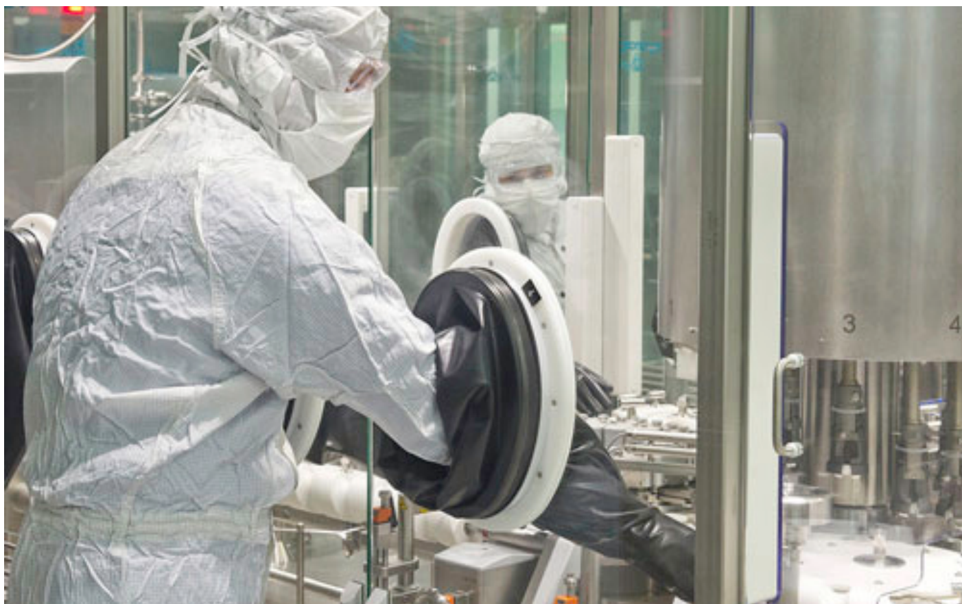
Handschuheingriffssystem: In der sterilen Fertigung wird durch das von Teva gewählte Handschuheingriffssystem der Kontakt von Mitarbeitern mit dem offenem Produkt nahezu vollständig vermieden, Copyright Teva GmbH.
