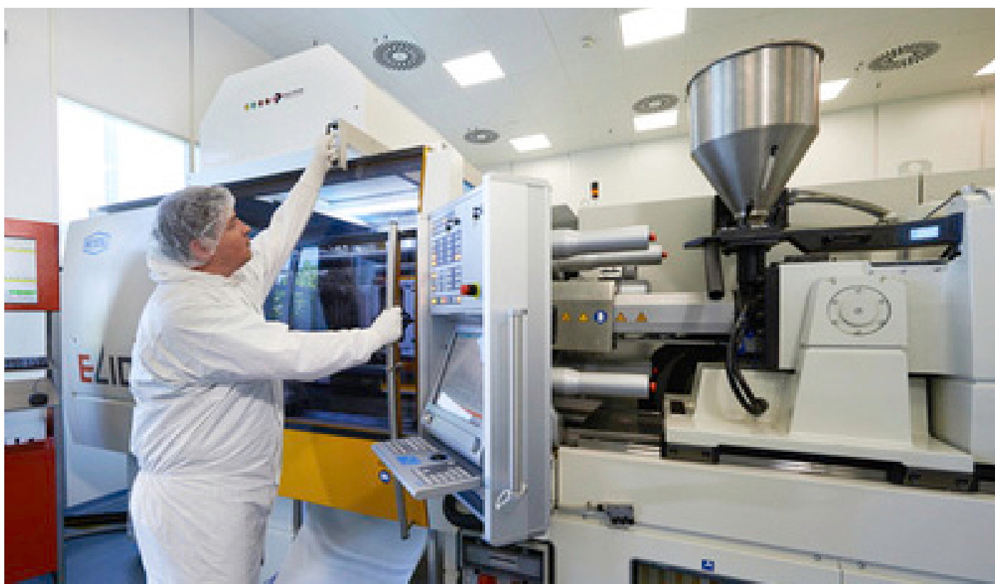
Integrierte Laminarflow-Hauben erzeugen im Spritzgießbereich eine Reinraumumgebung der Klasse 7
