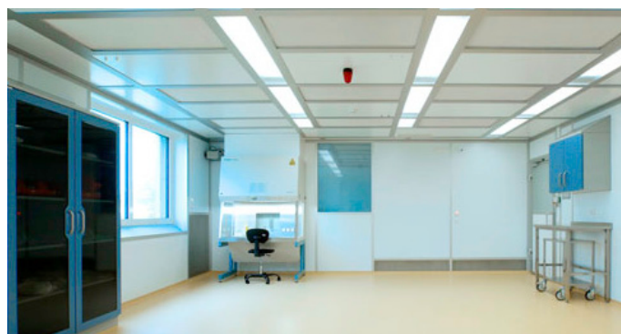
Das Zytostatikabor CleanSteriCell® erreicht die Reinraumklasse GMP A in B.
