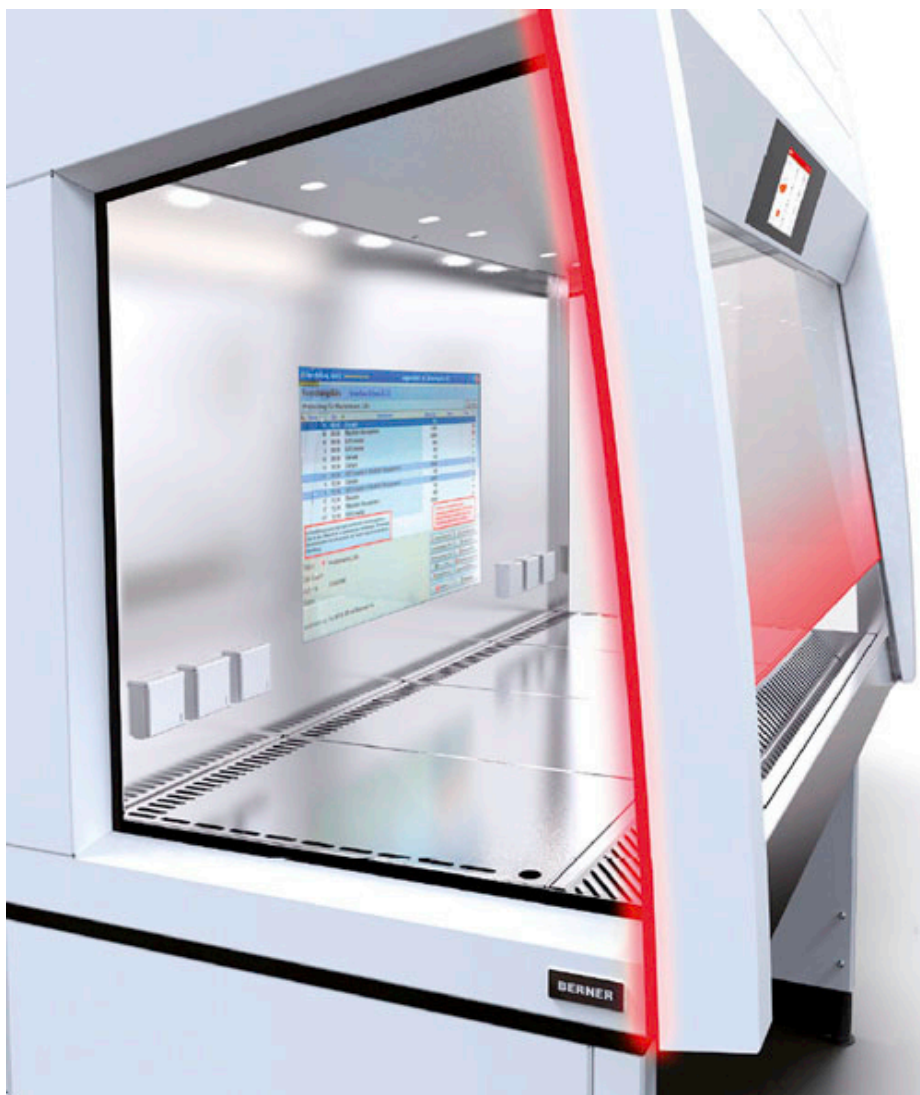
Abb. 6: Seitliches LED-Lichtband und beleuchtete Scheibenunterkante signalisieren den unsicheren Betriebszustand
