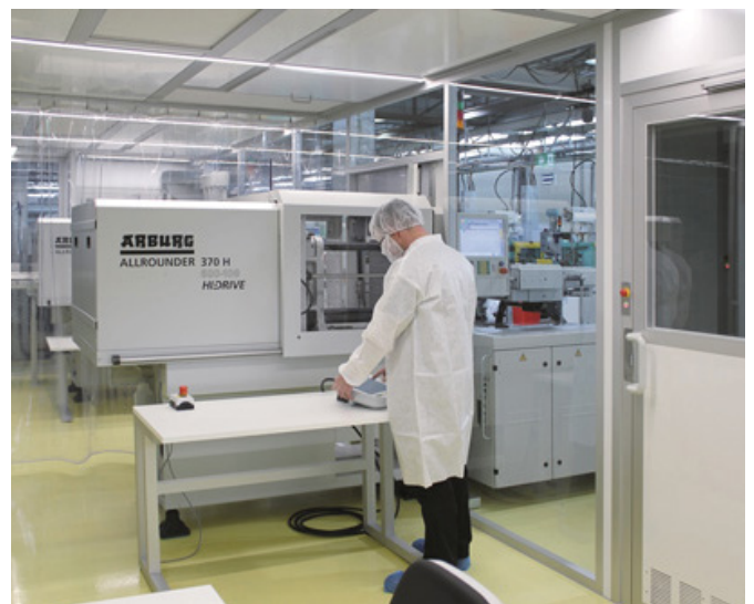
In dem Reinraum CleanCell4.0® können die gefertigten Teile direkt entnommen werden.
