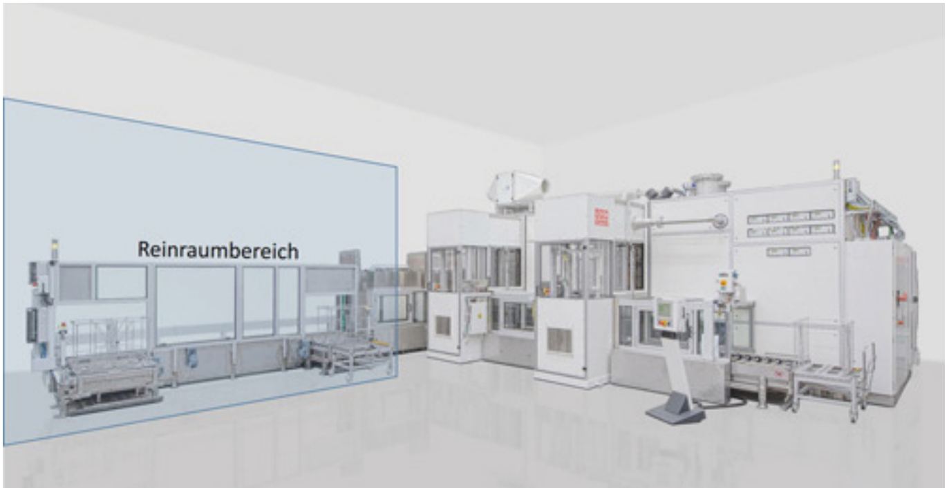
1. CNp-/US-Doppelkammeranlage für die Feinstreinigung mit direkter Anbindung an einen Reinraum. (Fotos/Schaubilder: LPW Reinigungssysteme GmbH)
