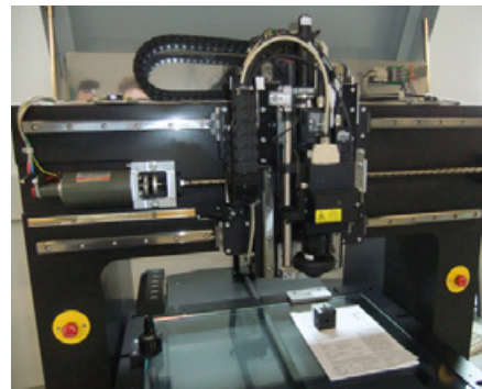
Die Präzision und Langzeitstabilität dieser im Betrieb mechanisch belasteten Baugruppen spielt bei der Gesamtauslegung der Messmaschinen eine entscheidende Rolle. (Bild: Dr. Erich TRETTER GmbH + Co.)
