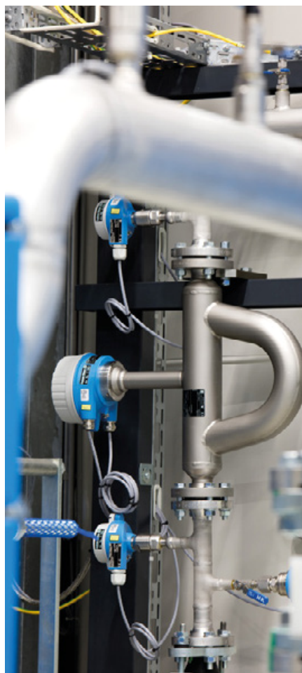
Abb. 2: Mit hoher Messgenauigkeit bei Massefluss und Dichte – für lockere Eiscreme und andere besondere Aufgaben in der Prozessanalytik. (Foto: Endress + Hauser)
