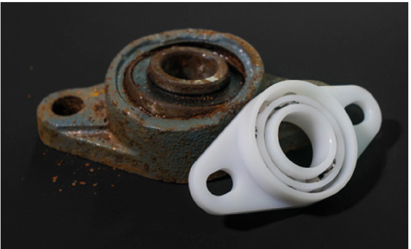
2-Loch-Flanschlager aus Metall und xiros Flanschlager aus xirodur B180 nach dem Salzwasserversuch im Testlabor. Am verschleißfesten xiros Lager mit online berechenbarer Lebensdauer sind weder Korrosion noch Verfärbungen erkennbar. (Quelle: igus GmbH)
