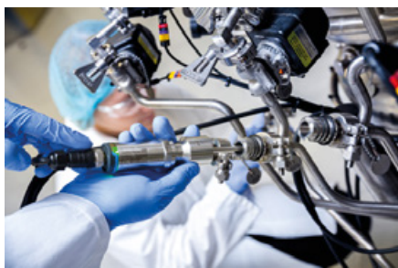
Abb. 1: Ein neuer selbstkalibrierender Temperaturfühler macht in einer Öl- und Fett-Produktion 3000 Prozessunterbrechungen pro Jahr unnötig. (Foto: Endress + Hauser)
