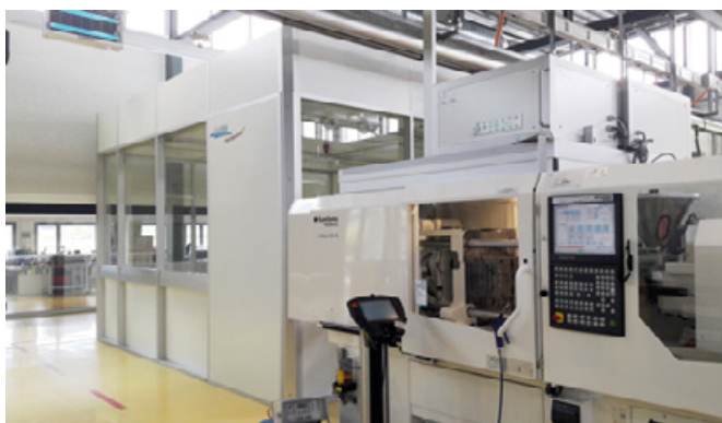
Reinraumlösung mit angedockter Spritzgießmaschine
