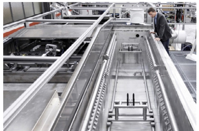
2. Die Kammertechnologie eignet sich auch für die Feinstreinigung von Großbauteilen (hier: ca. 4.000 x 700 x 700 mm Aluminium). (Fotos/Schaubilder: LPW Reinigungssysteme GmbH)
