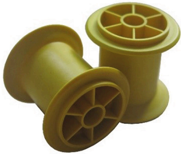
Abb. 2: Spritzgegossene Garnspulen (gelb eingefärbt) aus PLA_6202/GN_40 (60/40 w/w)
