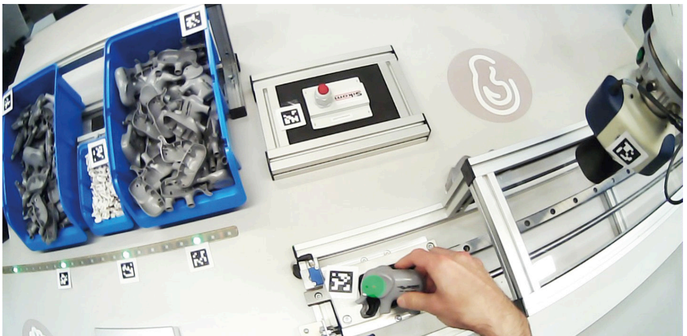
Die Eye-Tracking-Systeme legen offen, welche Bereiche des Arbeitsplatzes der Monteur am längsten im Blick hat, welche er nur flüchtig anschaut und welche er gar nicht wahrnimmt. (Quelle: Fraunhofer IPA)
