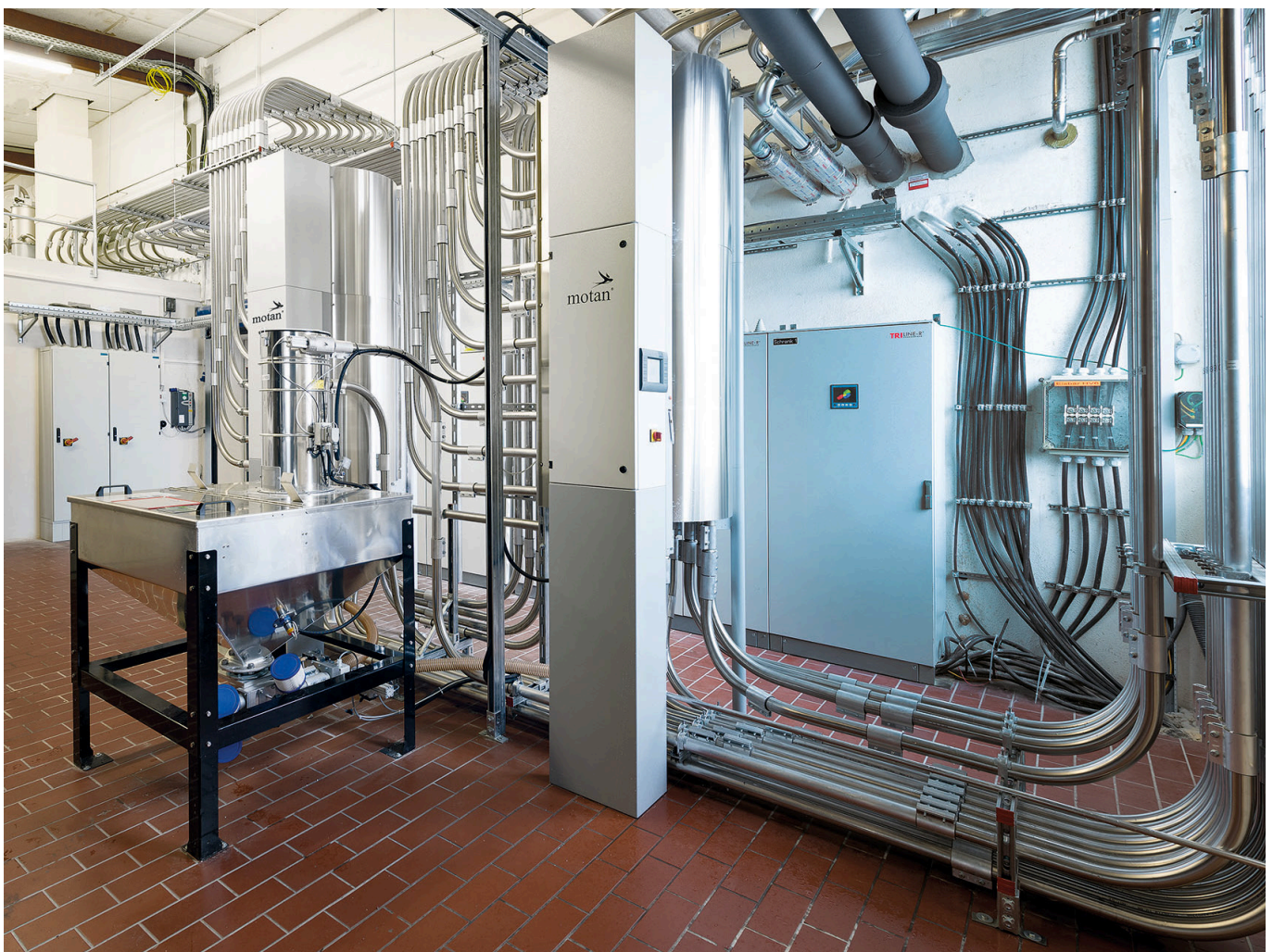
Der METROLINK Verteilbahnhof besteht aus zwei Einheiten, die automatisch je zehn Eingänge auf zehn Ziele verteilen können. Die Anlage ist mit geringem Aufwand jederzeit erweiterbar. (Bild: motan-colortronic)
