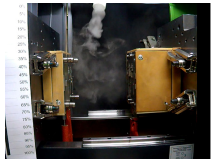
Bild 3. Bei einer Werkzeugtemperatur von 140 °C könnte nur durch eine Erhöhung der Strömungsgeschwindigkeit eine Durchströmung erreicht werden, was aufgrund der festgesetzten Geschwindigkeit von 0,45 m/s in der Praxis jedoch nicht erlaubt ist. (Bild: Engel)
