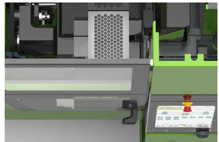
Bild 4. Um auch bei hohen Werkzeugtemperaturen die Partikellast gering zu halten, bietet es sich an, die Reinluftströmung umzukehren. ENGEL AUSTRIA und Max Petek Reinraumtechnik haben dafür eine erste industrielle Lösung umgesetzt. Der Blick in den Werkzeugraum zeigt das Luftgitter, durch das die Reinraumluft nach oben geblasen wird. (Bild: Engel)
