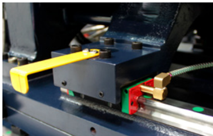
Für eine lange Lebensdauer und hohe Verfügbarkeit der TE-Baureihe wurde ein Kugelgewinde (RAM-Box) mit hoher Belastbarkeit verwandt. (Bildquelle: WOOJIN Plaimm GmbH)
