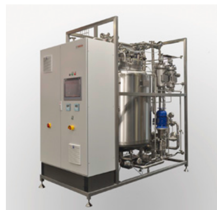
CIP-Anlage von Bosch für Einsatz bei Humanimpfstoffen: Die CIP-Anlage in kompakter Skid-Bauweise eignet sich für die Reinigung und Abwasserinaktivierung von Prozessanlagen zur Herstellung von Humanimpfstoffen.
