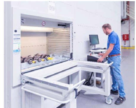
Der Lean-Lift ist Lager und Materialschleuse in einem.
