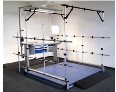
In Kooperation mit dem Fraunhofer IPA Stuttgart entwickelte RK Rose+Krieger ein biomechanisches Labor zur Erfassung der Bewegungsabläufe arbeitender Menschen und der auf sie wirkenden Kräfte.
