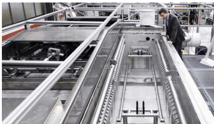
Die Kammertechnologie eignet sich auch für die Feinreinigung. (Fotos/Schaubilder: LPW Reinigungssysteme GmbH)
