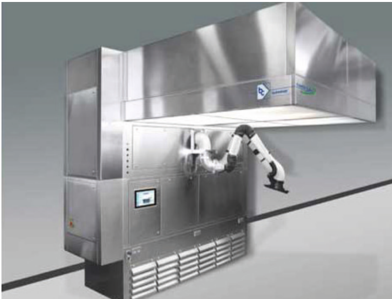
Bei den Wiegekabinen lassen sich durch die abwärts gerichtete Reinstluftströmung im Inneren manuelle Umfüllprozesse von pulverförmigen Einsatzstoffen in einer mikrobiologisch kontrollierten Produktionsumgebung durchführen. (Quelle: bc-technology)
