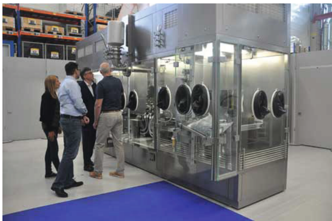
Kompakte Bauweise für höhere Effizienz: die AFG 5000: Die kompakte Bauweise der AFG 5000 spart Platz und Kosten im Reinraum. (Foto: Bosch)
