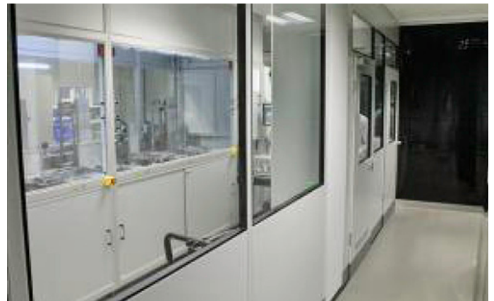
Der Montage vorgelagert und in den Reinraum integriert ist eine 7-Zonen-Ultraschallreini- gungsanlage, die das gesäuberte Material direkt in den Montagebereich fördert. Sie wurde parallel zum Reinraum beschafft und musste in die Planung integriert werden. (Quelle: Nerling Systemräume GmbH)
