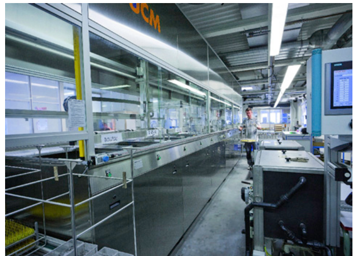
Die erste Reinigungsstufe der Ultraschallanlage für die Produktionsendreinigung ist mit drei separaten Reinigungsbecken ausgeführt. Dies ermöglicht, die Teile aus verschiedenen Werkstoffen getrennt zu reinigen.
