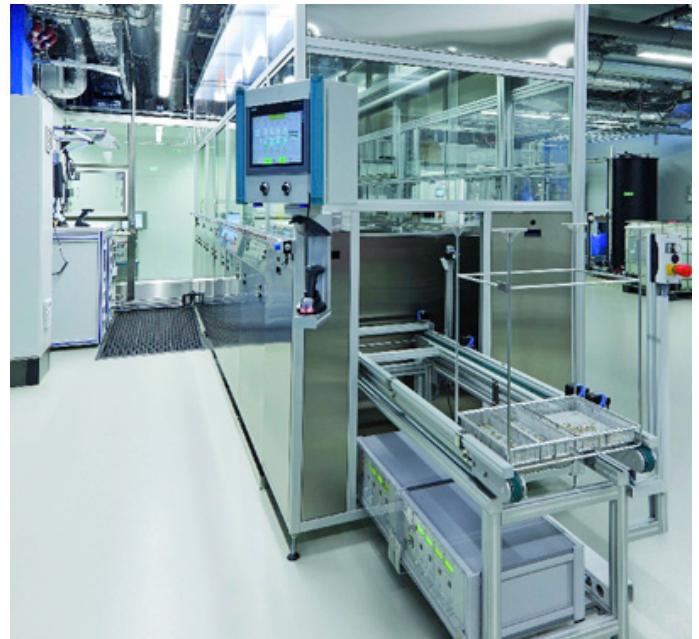
Bei der Anlage für die Endreinigung werden die Teile direkt in den Reinraum ausgegeben. Die Anlage und die Transporteinheit in den Reinraum sind vollständig gekapselt.
