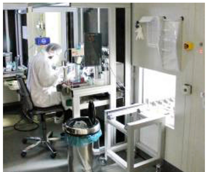
Um die hohe Reinheitsklasse in den Flowboxen zu ermöglichen und alle Komponenten möglichst partikelfrei zu halten, muss auch außerhalb der Boxen, in der Reinraumkabine, eine nahe Reinheitsklasse eingehalten werden. Der Reinraum hat daher die Klasse ISO 8 und verfügt über einen zusätzlichen Montagebereich der Klasse ISO 7. (Quelle: Nerling Systemräume GmbH)
