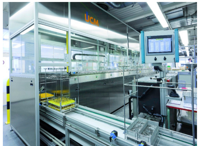
Für die Produktionsendreinigung der unterschiedlichen Teile sind 16 Programme in der Anlagensteuerung hinterlegt.
