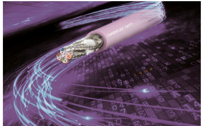
Um eine hohe Datensicherheit in schnellen Energieketten zu gewährleisten besitzt die CAT7-Leitung CFBUS.052 Geflecht-, Paarschirme und einen Geflechtgesamtshield mit 90 Prozent optischer Bedeckung. (Quelle: igus GmbH)
