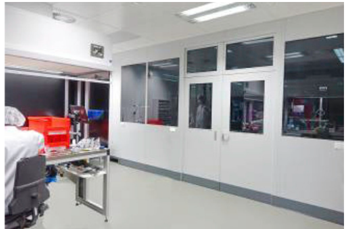
Das gesamte Wand- und Decken-System, das bei TRUMPF verwendet wurde, ist freiste- hend. Zudem ist die Raumanlage modular aufgebaut und dadurch sowohl leicht erweiter- als auch demontierbar. (Quelle: Nerling Systemräume GmbH)
