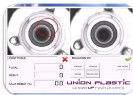
O-Ring-Verletzung (links) im Vergleich zum IO-Teil (rechts).
